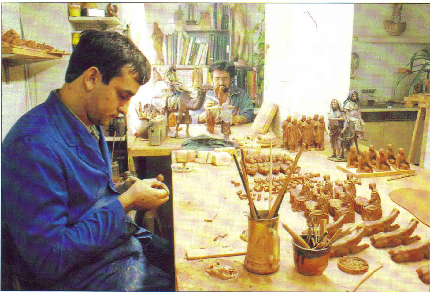
*Tras haber modelado la figura, nuestro artesano fabrica un molde de escayola; con éste podrá fabricar en torno a un centenar de reproducciones.*
